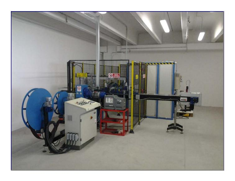
本机为自动化砂轮生产设备,以无纺布、无纺布和布复合材料为原料。尺寸:直径 100、110、120 mm;高度 100 mm。
