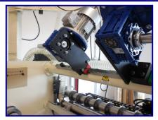
剪切机/卷绕机设计用于通过压力或剪切系统剪切和卷绕较窄的砂纸和砂布卷。该设备由集成 PLC 系统控制,配有广角触摸显示屏,可以通过多种自定义解决方案控制编程。用户可以借助专用界面,对电磁制动器、矢量逆变器马达(作为离合器使用)进行自动化实时控制。本设备配备一套开卷机和卷绕机,开卷机和卷绕机配有阳极氧化铝可扩展轴(直径为 76 mm 或可变的定制尺寸)和滑动或倾斜块。
