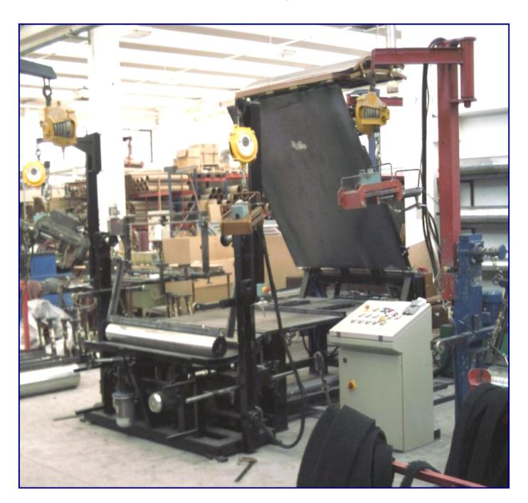
本机用于生产磨辊;最大工作直径为 500mm 标准长度为 1500mm。液压缸对材料进行冲压,并由两名操作员将材料放入模具中。本机提供了一种非常灵活的选项,可以加工不同尺寸的产品。
