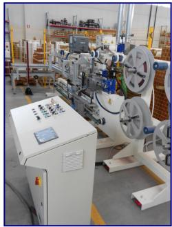
这种半自动设备可以生产带法兰的砂布制砂轮,产品直径在 165mm 到 350mm 之间,厚度可达 100mm。本设备可以全自动剪切和缠绕砂布翼片,翼片随后储存在工艺末端的设备中。本设备配备多功能触控面板,可设置和储存操作员自定义的程序。
