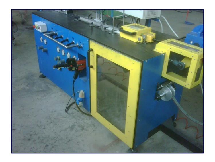
手动无纺布砂轮加工机,加工砂轮尺寸为 100x100、110x100 和 120x100 mm。轴直径在 60 到 120 mm 之间。
