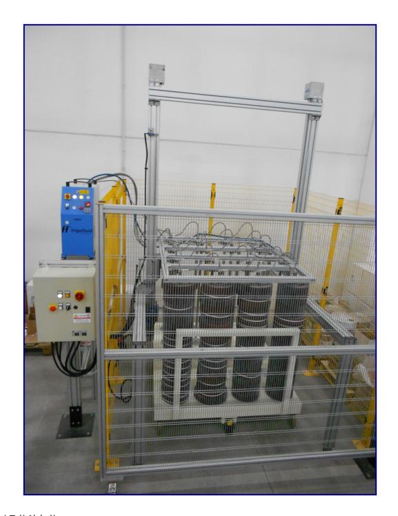
固化炉通过导热油加热。
