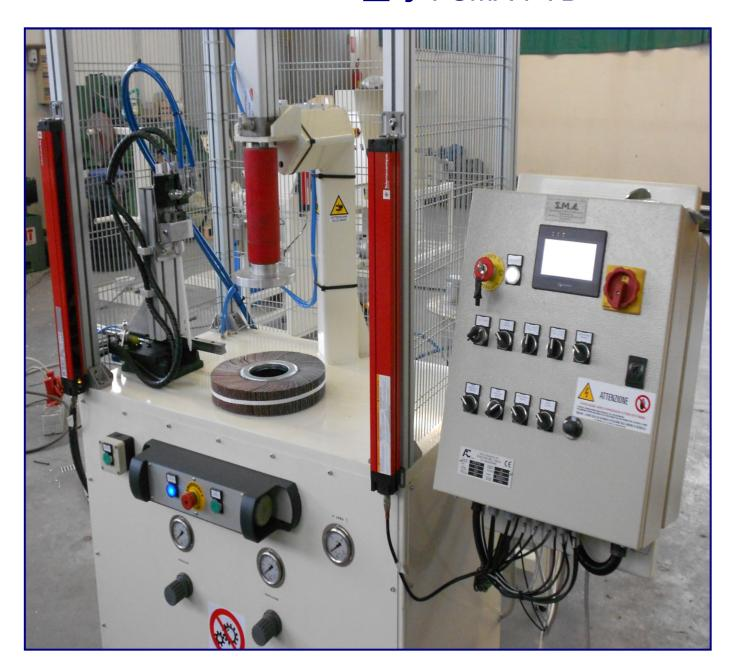
本设备提供了冲压制造带法兰砂布砂轮和槽内树脂涂层的自动化加工工艺。本设备设计合理,确保翼片砂轮的两个法兰完全平行,并提高法兰打胶带给砂布翼片的机械阻力。
