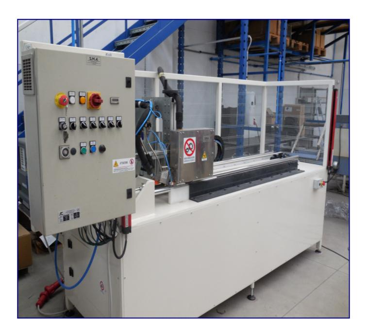
这是一种自动化设备,可粘结翼片组。用户可通过液压缸自动压缩三到六组翼片,然后进行切割,用热熔胶 打胶,并最终通过 X 空气系统冷却。
