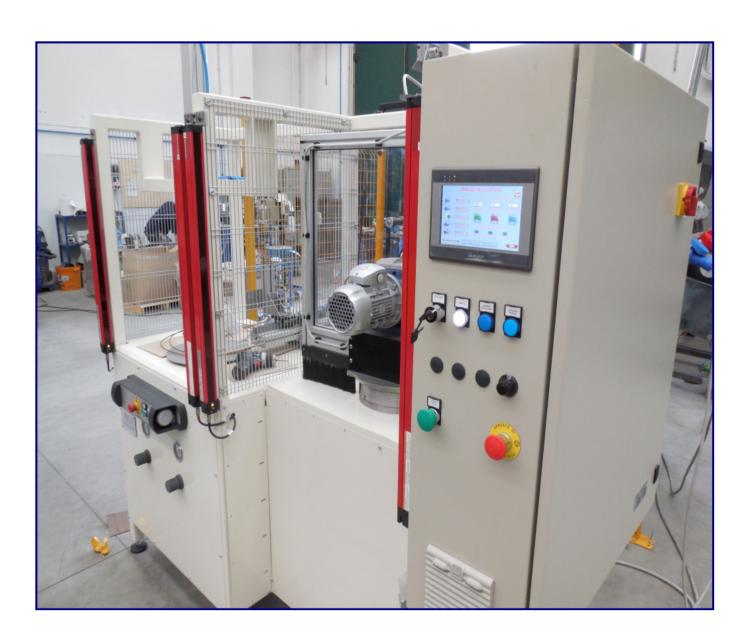
这套组合系统设计用于对砂轮进行冲压、粘结和离心加工。系统可以通过带有操作面板的多功能 PLC 控制,操作面板可以监控整个加工流程。系统包括两个工作站:一个工作站用于粘结和冲压,另外一个工作站用于离心加工。
