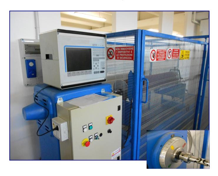
本机为动态平衡机,带有刚性支架。
