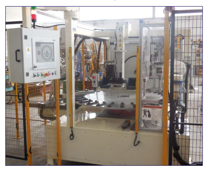
本机为自动化机器,用于轴装翼片砂轮打胶。
