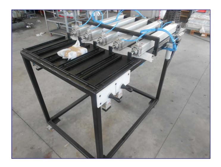
移动式布砂轮成型工作台,砂轮尺寸为 100x100 和 100x50mm。
