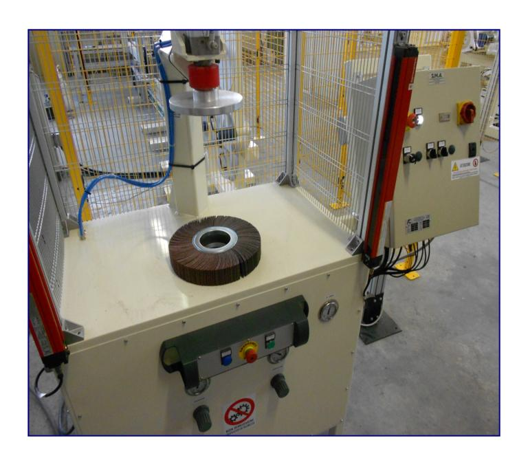
本设备提供了压制带法兰砂布砂轮的自动化加工工艺。
