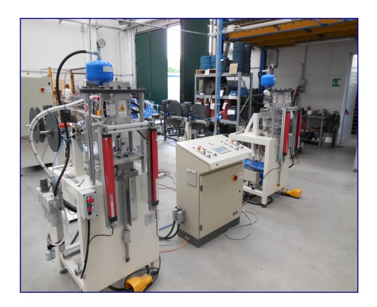
这种半自动设备可以生产带法兰的砂布砂轮,产品直径在 165mm 到 350mm 之间,厚度可达 100mm。首先将砂布剪切成翼片,随后储存在垂直加载器中。本设备配备多功能触控面板,可设置和储存操作员自定义的程序。
