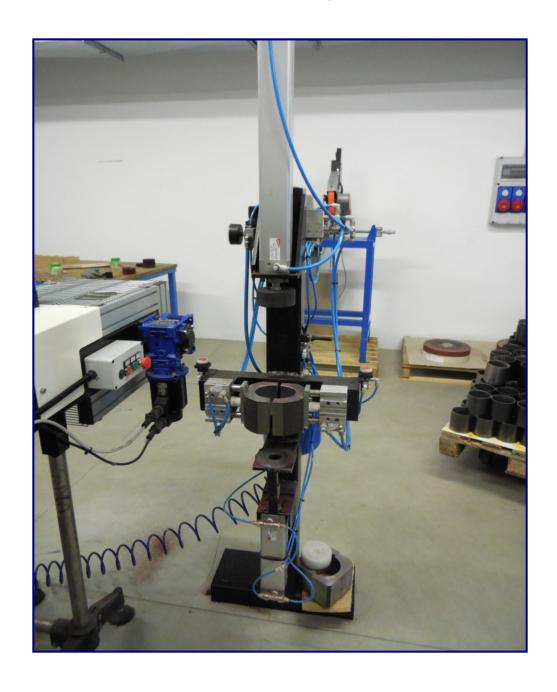
本机为同心压缩机,设计用于将 SMA-TFN 和 SMA-TFNW 制造的无纺布砂轮插入到金属模具中。通过同时关闭两个气动夹钳,设备可以同时进行材料压缩,并将其插入到固定缸中。 本机完全由带有双手安全模块的气动阀门控制。
