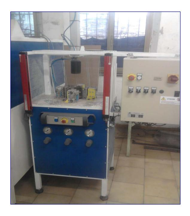
本机为同心压缩机,设计用于将 SMA-TFN 和 SMA-TFNW 制造的无纺布砂轮插入到金属模具中。通过同时关闭四个气动夹钳,设备可以同时进行材料压缩,并将其插入到固定缸中。
