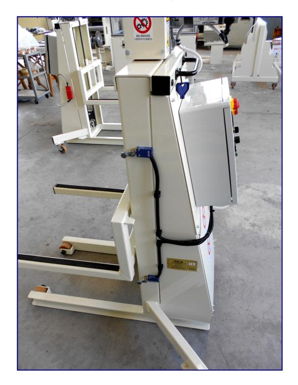
CR 半电动叉车使用 12V 电瓶提供升降动力,方便人工搬运设备。这是搬运较轻到中等重量物品的理想选择。 货叉可以通过机身上的按钮开关升降。
