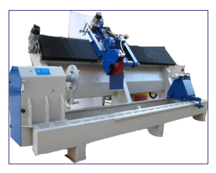
本机为自动化无纺布磨辊切割和研磨设备;最大工作直径为 500mm 长度为 2000mm。
