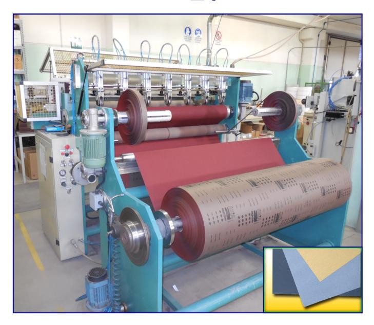
本机为砂布和砂纸卷自动切割设备,可以自动切割并整齐堆叠材料;本机包括一台通过盘形刀片操作的横向切割装置。切割频率非常高;可以加工各种砂布和砂纸。本系统由 PLC 和轴控制系统监控,控制系统为专门设计,用于控制执行材料切割的伺服电机的运动。
