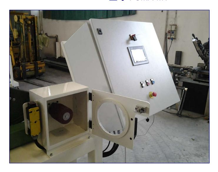
本机为自动化设备,可以对无纺布翼片研磨盘和砂轮进行速度测试。
