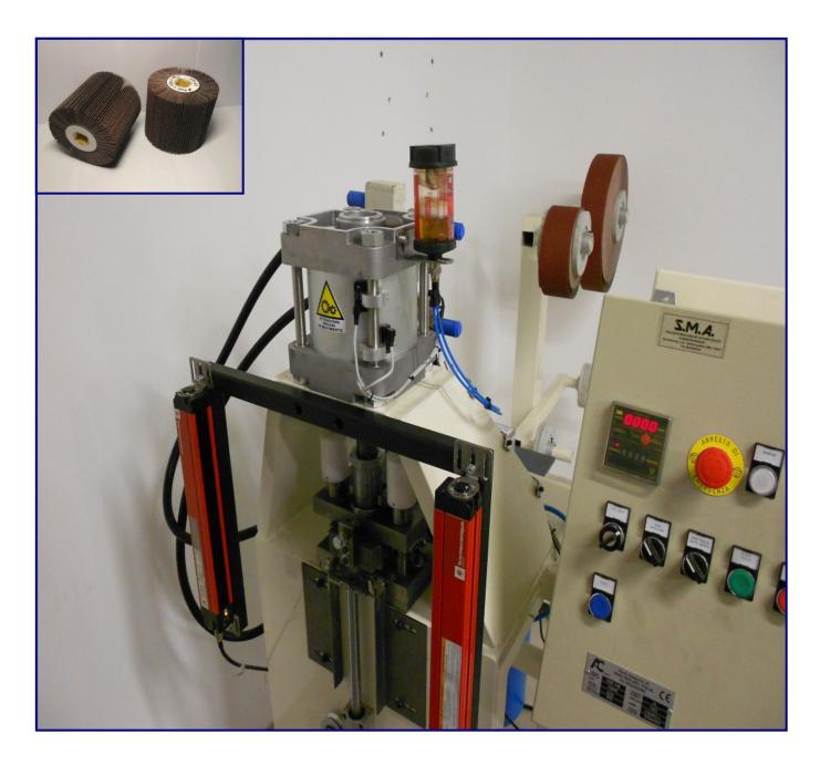
本机为半自动化设备,用于生产直径为 Ø 100 mm 的砂布砂轮。首先将砂布剪切成翼片,随后储存在垂直加载器中。本机设有面板和计数器,可选择要切割的翼片数量。本机为全气动设备:气动缸执行切割操作,通过气动压力进给装置执行材料进给。本设备是一种简单且低成本的选择。
