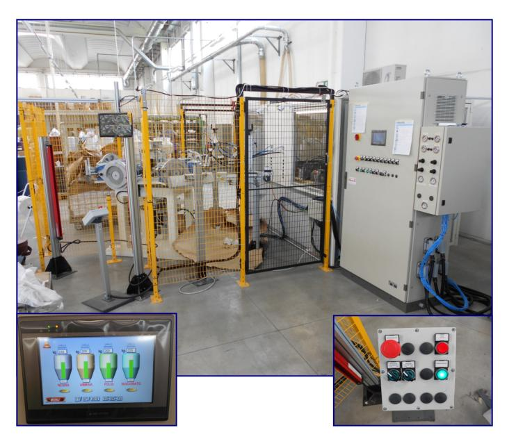
本机设计用于自动粘结带法兰的翼片砂轮。本机具有很好的通用性,可以生产直径从 110 mm 到 350 mm 的砂轮。
