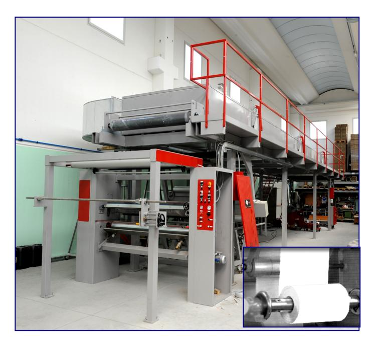
本机是将砂布和砂纸叠成 Velcro® 或海绵状的自动化设备。本设备设计用于加工大量砂布和砂纸卷。由多个电压和调校传感器自动控制,可以加工各种砂布和砂纸/非研磨性布和纸。
