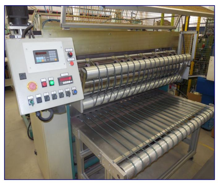
本机为自动翼片切割机,可以切割无纺布、砂纸或砂布等材料制成的翼片,切割高度等于原料卷高度;最大工作宽度为2000mm。该系统可切割预定数量的翼片,这些翼片用于在全自动模式中装配磨辊。切割通过圆形刀片执行,刀片由伺服电机移动以高精度和高速度执行切割。翼片接着会堆放在缓冲容器中,做好收集和加工准备。
