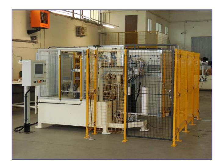
本机设计用于自动粘结翼片砂轮。
